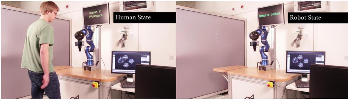
**Fig. 6: Top-screen expressing «Human-In-Workspace» (left) or «Robot-Locked» (right)**
